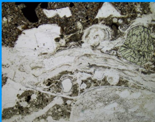
Fig.1a 劣化したコンクリート (単ニコル) The degraded concrete. (plane-polarized light)
