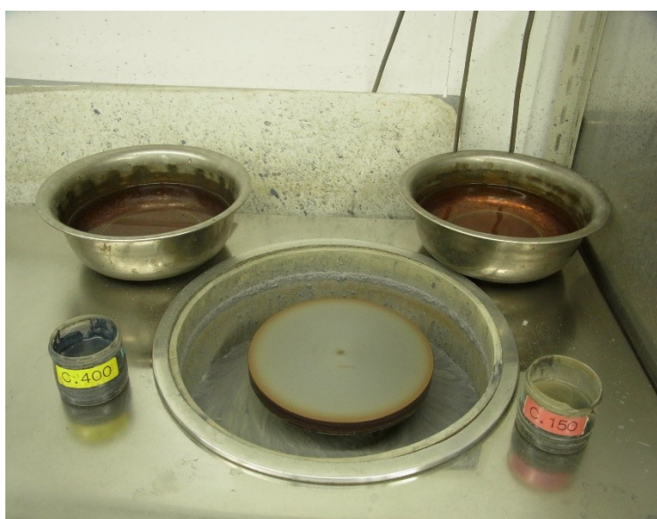
図一５：回転盤の傍らには水と研磨材が入った容器（左：#400，右：#150）。研磨材を変える時は手や回転盤をよく洗う。水の容器も必ず変える。
