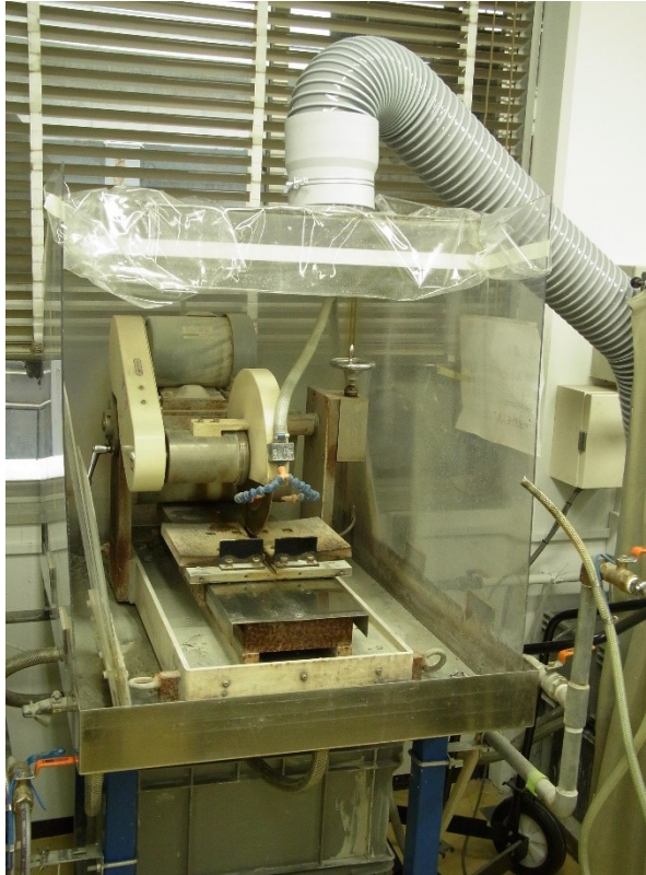
図一3：岩石切断機（図左）には集塵機（図右）が取り付けられている
