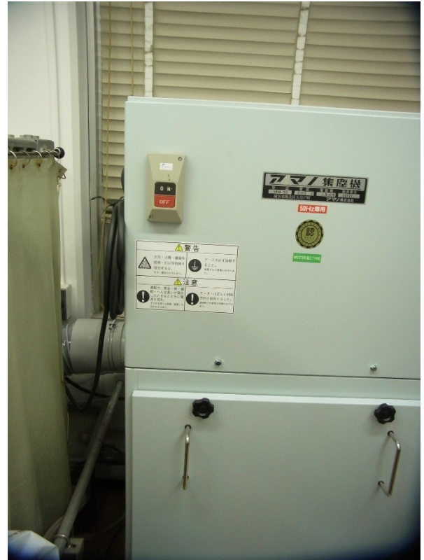
図一3：岩石切断機（図左）には集塵機（図右）が取り付けられている
