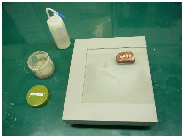
図一七：ガラス板をセットした台。研磨材、水、均し石などを用意する。準備は研磨材の番号の大きいもの（細粒）から行う。後片付けも同じ順序で行う。
