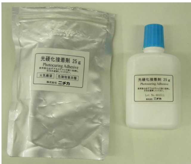
図一26：袋から取り出した紫外線硬化型樹脂（図右）
