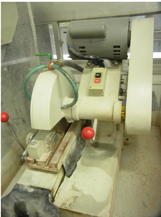
図一13：成形用の岩石切断機
