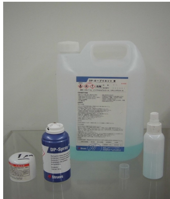
図一19：ダイヤモンドの研磨剤（左図）と潤滑剤（商品名：ルブリカント）とそれを入れた容器（右図）。
