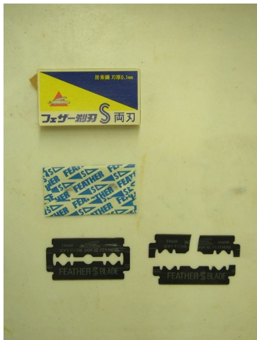
図一28 : カミソリの刃は1 / 4に折って使う (図右下)
