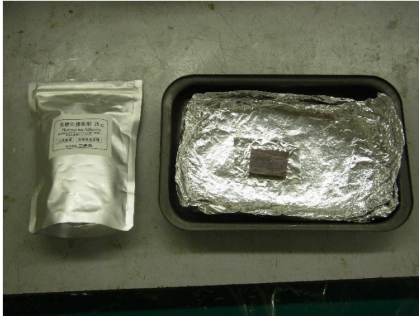
図一11：袋に入っている光硬化型接着剤（左図）と接着する試料（右図）
