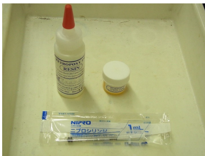
図一9：ペトロポキシ（商品名）は主剤（上図左）と硬化剤（上図右）を10：1で混合させる。シリンジ（下図）を使って正確に測る。
