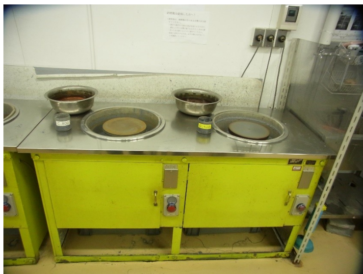
図一４：２連式のグラインダー。使用する研磨材は左右で変える（左：#800，右：#400）。電源スイッチは膝を使って押せるようになっている
