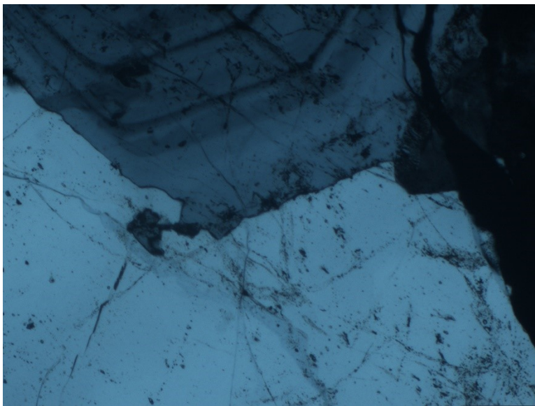
図一17：石英（下部）が灰色で終了。上部の累帯構造が見えるのは斜長石。ともに灰色にする。
