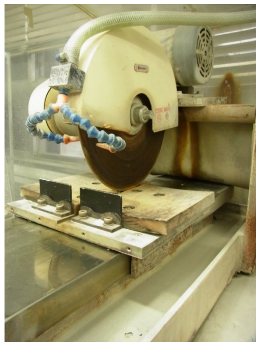
図二：岩石切断機の刃が下の台より下にあることを最初に確認する
